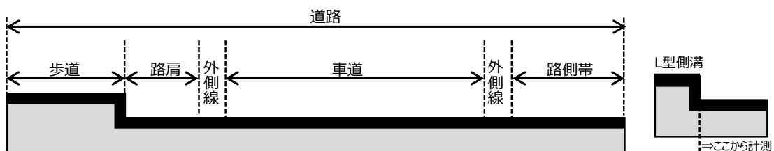
図 4.3 道路の幅員構成
