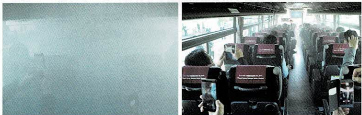
【長野県バス協会の換気性能の実演】 左：貸切バスの車内にスモークを充満させ、右：エアコンの換気を作動させると5分後にはほぼ元の状態に（長電バス）
