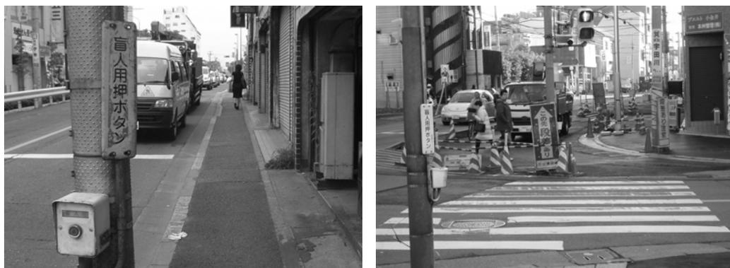
写真 5-4 音響式信号機の設置例（小金井市内）
