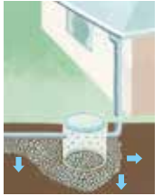
雨水浸透ます
