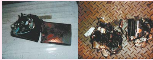
市内で回収したプラスチックごみに混入され発火した電池類
