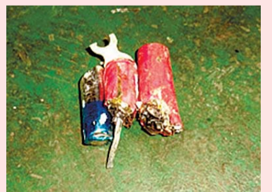
処理中に発火した乾電池
