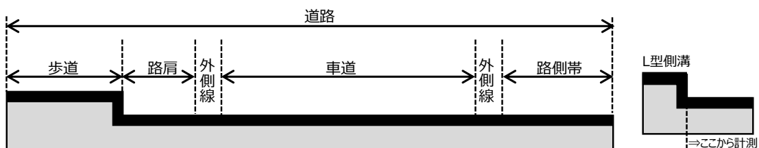
図 4.3 道路の幅員構成
