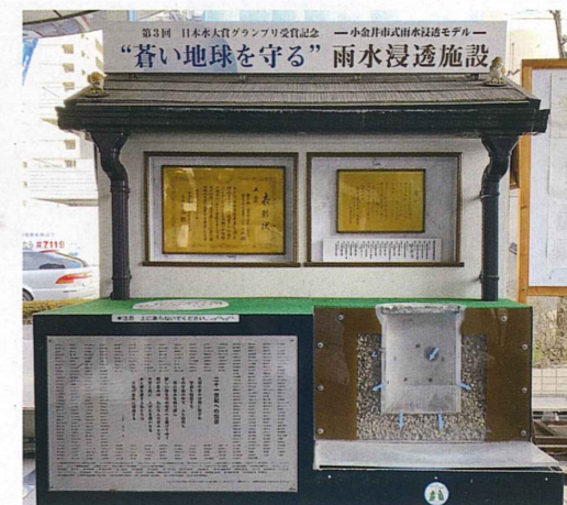
小金井市役所第二庁舎 1階に展示している「小金井市式雨水浸透モデル」
