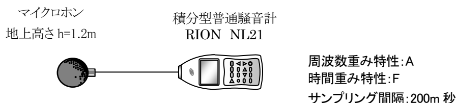
図 2.3 測定機器の構成図(騒音レベル)
