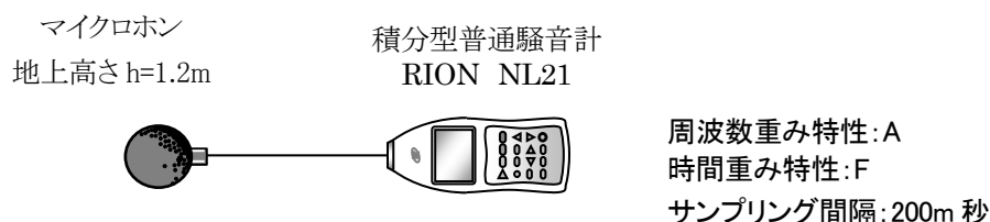
図 2.3 測定機器の構成図(騒音レベル)
